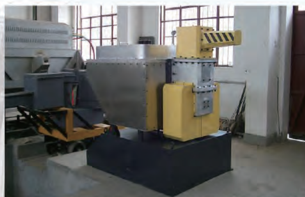
电磁泵定量浇注系统
