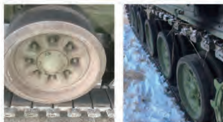
本成果石墨烯改性橡胶制备的负重轮外挂胎体
